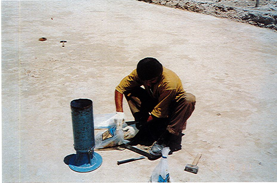
فحص التربة بعد الدك لقياس درجة الفراغ
