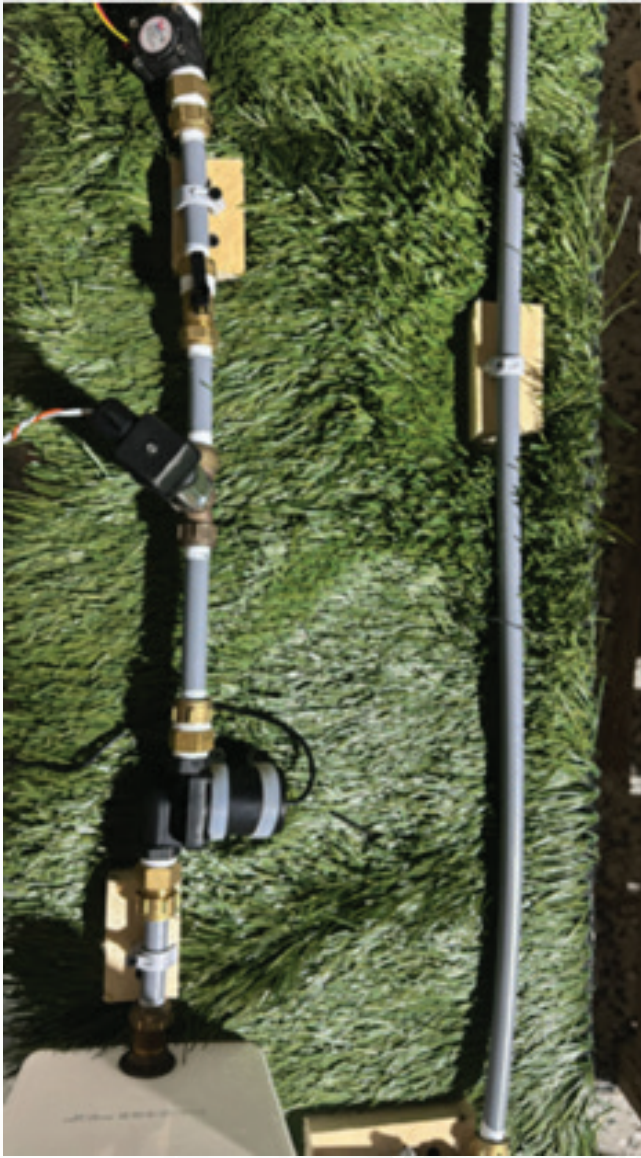
التجميع النهائي للمضخة والصمام وأجهزة الاستشعار على أنابيب المياه
