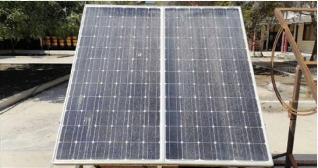
لوحة كهروضوئية مغبرة على اليمين، لوحة كهروضوئية مغبرة جدًا على اليسار
